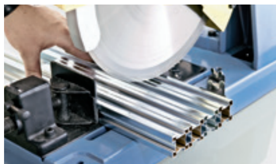
↑ Op til fire Geberit GIS profiler kan afkortes på samme tid med geringssaven.
