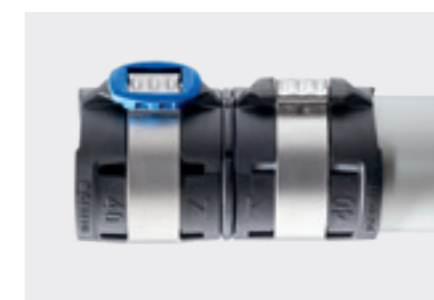
Let at identificere, selv i mørke hjørner: Enten er presseindikatoren stadig på fittingen eller også er samlingen allerede presset.
