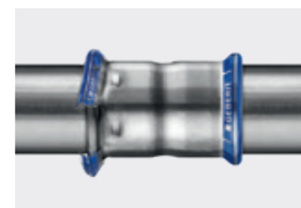
Farvede indikatorer identificerer upressede Mapress fittings selv før trykprøvningen.
