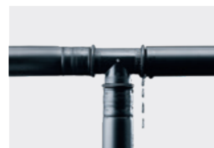
Definerede lækageveje gør upressede fittings synlige med det samme i trykprøvningen.
